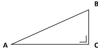
Ce rapport permet de calculer des hauteurs inaccessibles à partir de mesures horizontales ; il donne aussi le **coefficient de forme des rectangles** semblables formés à partir de ces triangles rectangles.
